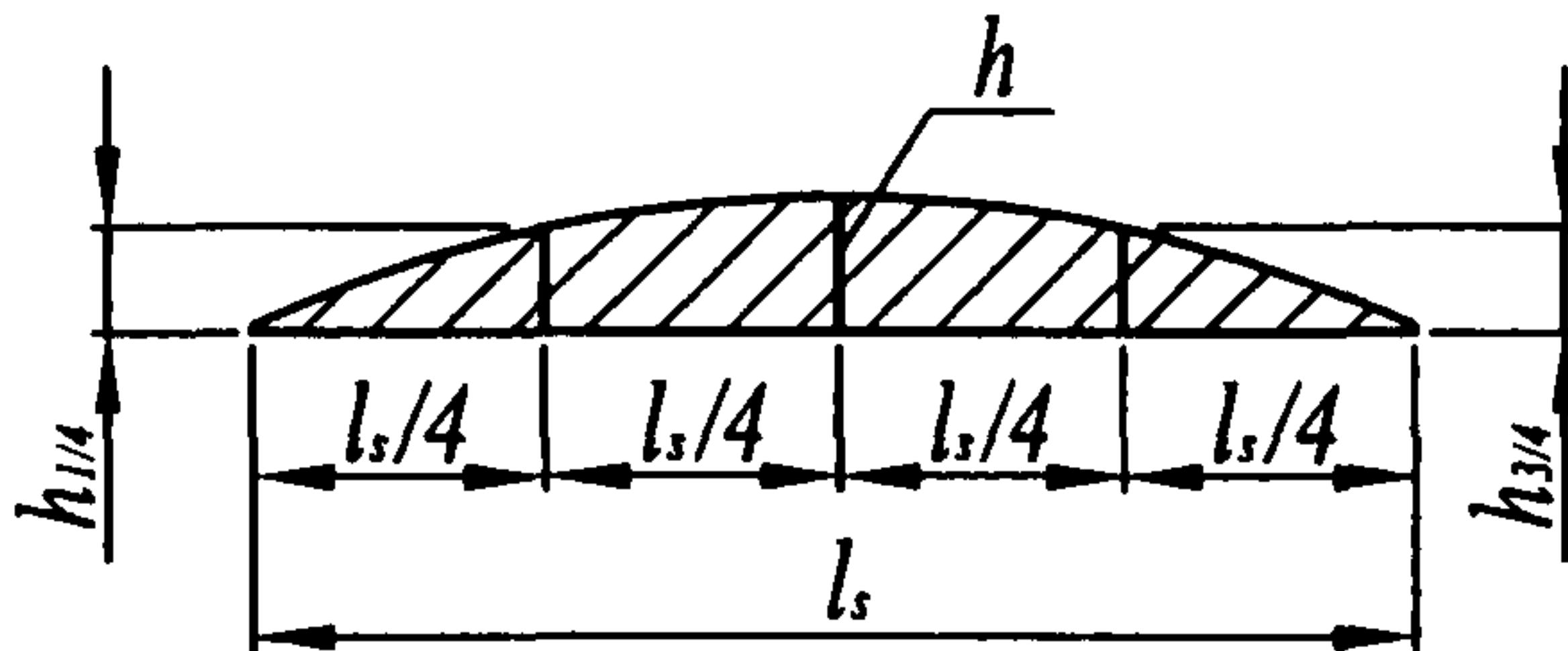
Рисунок 3 - Определение площади боковой поверхности одного поперечного ребра, Fr (сечение В-В из рисунка 1)
